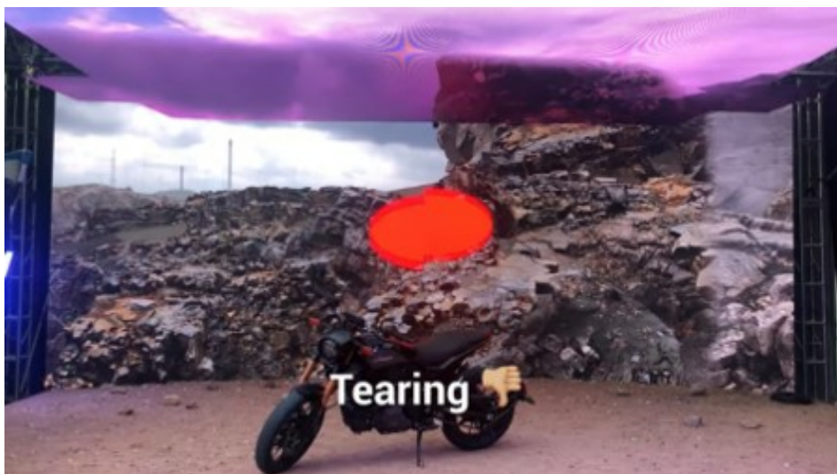
Fot. 378. Synchronizacja nieprawidłowa – połówki czerwonego pola przesunięte względem siebie, źródło: https://www.youtube.com/watch?v=vyYXLEz0k1Y
