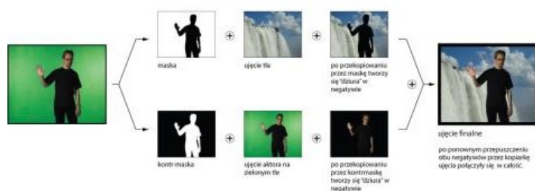
Fot. 153. Technika maskowania – schemat, źródło: http://3.bp.blogspot.com/-ERfi9I0jBco/Tm4r9ZTu7gI/AAAAAAAAAONE/mBdu6M3F65c/s1600/schemat.jpg
